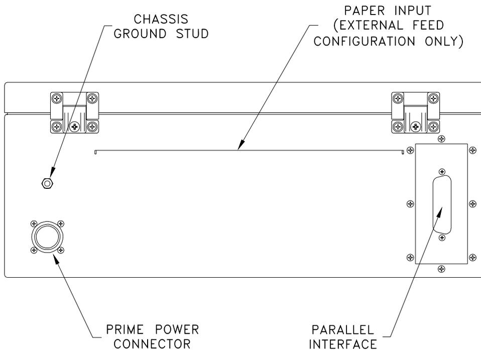
NOTE: POWER CONNECTOR AND GROUND STUD LOCATIONS SHOWN ARE TYPICAL.
