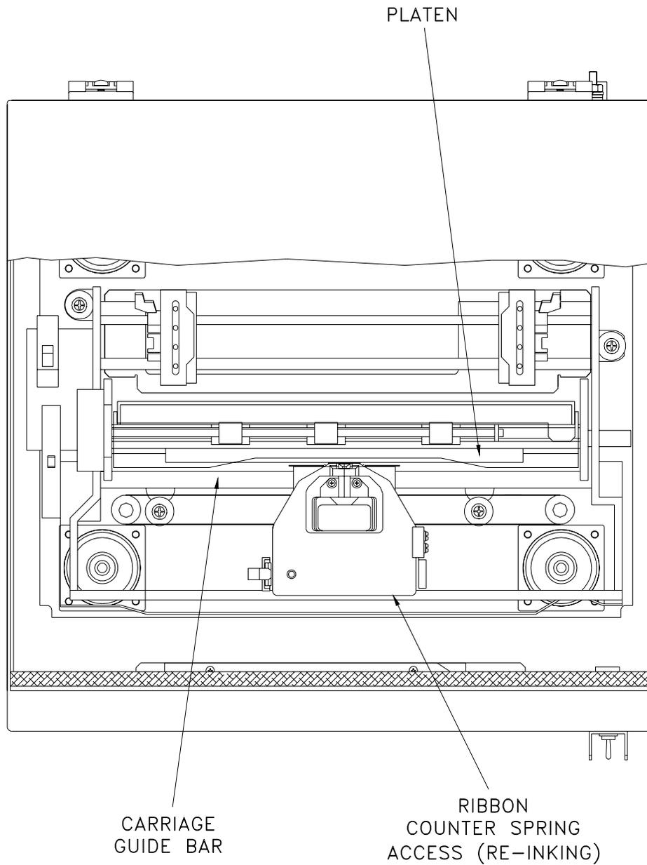
NOTE: MAINTENANCE LOCATIONS SHOWN ARE TYPICAL FOR ALL MODEL 2x00 PRINTER CONFIGURATIONS.
